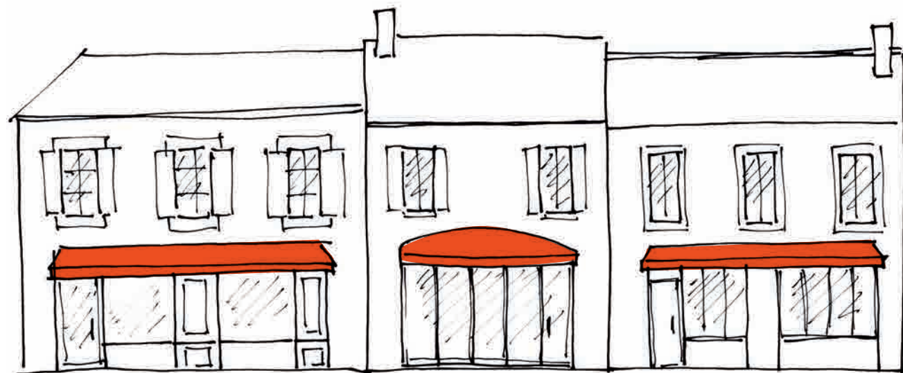
Les stores perturbent l'architecture de la rue. Les formes compliquées rendent peu lisibles l'organisation du bâti. Ils ne respectent pas le percement des vitrines.
