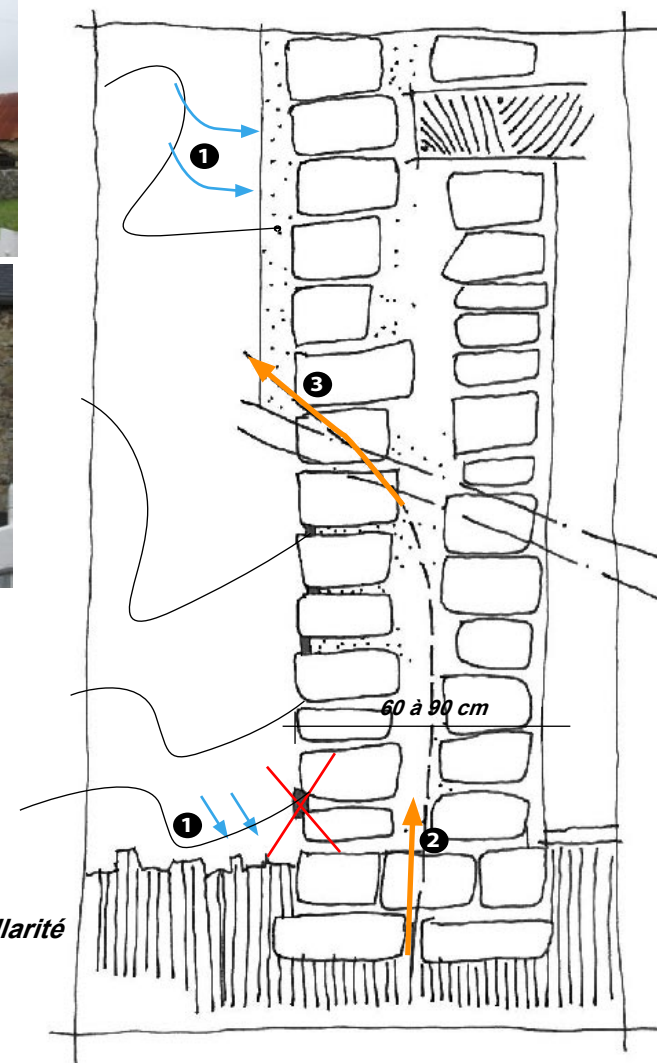
Restauration d'un mur traditionnel en pierre - Principe du mur respirant
